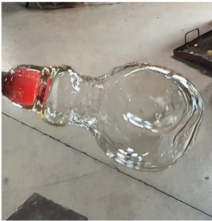
4. DISTACCO FORMA - Il vetro viene rimosso dallo stampo, la forma è irregolare.
