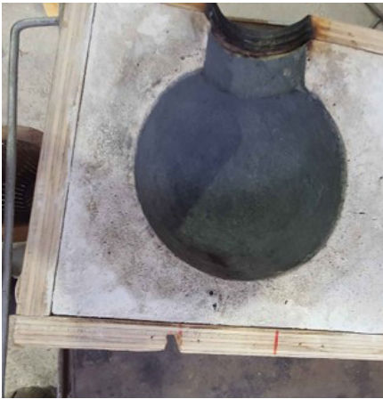
1. STAMPO PER COLATA - Scatola in legno e controstampo in PLA prodotta tramite FFI.
