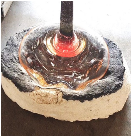
3. SOFFIATURA - Il vetro viene soffiato tramite canna facendo aderire il vetro fuso alle pareti dello stampo.
