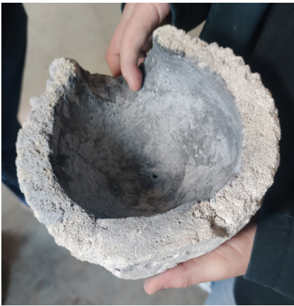
2. DISTACCANTE - Sulla superficie viene applicato un distaccante (bonderite etc.).
